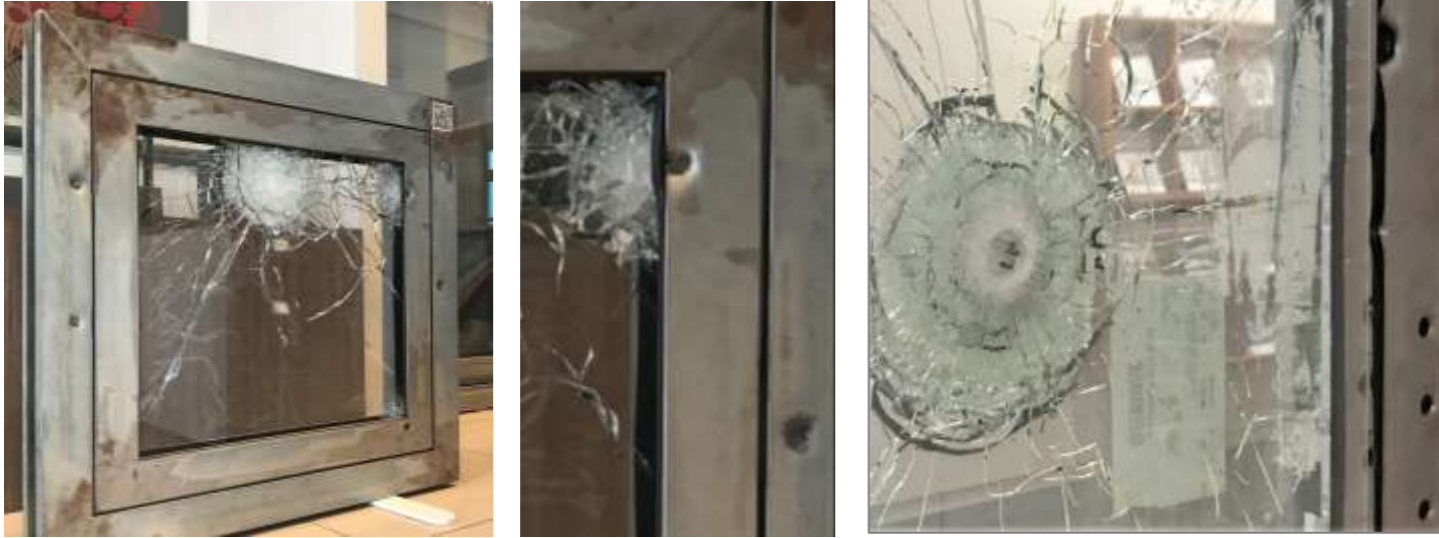
Test edilmiş FB7 –BR7 kurşun geçirmez camlı doğrama
